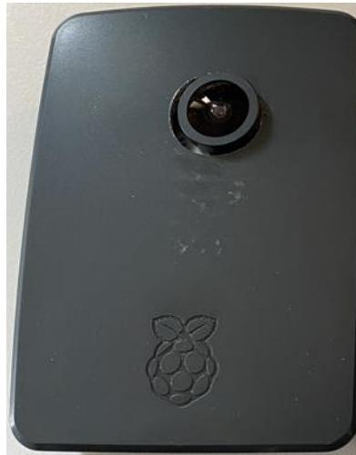
Abbildung 45 Raspberry Pi mit Deckel.
