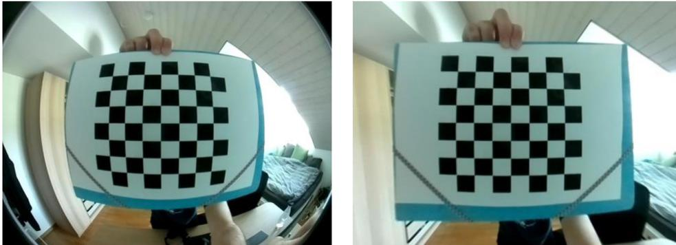
Abbildung 2 Vergleich des verzerrten Bildes (links) und dem Resultat der Entzerrung (rechts).
