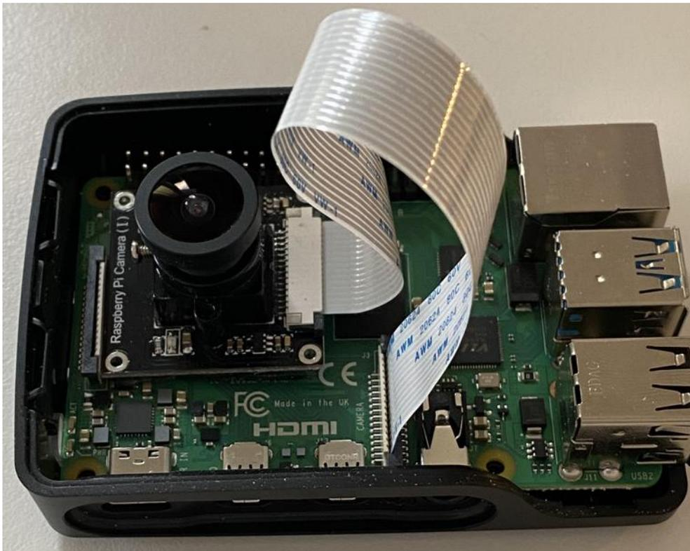
Abbildung 44 Raspberry Pi mit installiertem Kameramodul.
