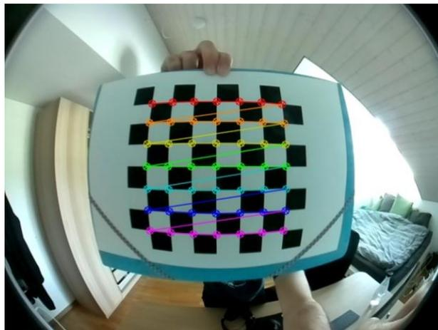
Abbildung 1 Verzerrtes Kamerabild mit gefundenen Punkten im Schachbrettmuster.
